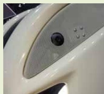
Querverkehrskameras sind hier an beiden Seiten in der Motorhaube des Traktors montiert.
