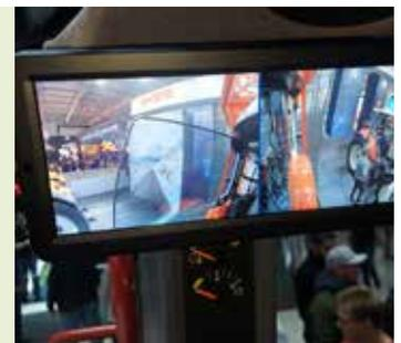
Auf einem Traktor mit Forstausrüstung sind links im Bild anstatt der Rückspiegel zwei gut verstellbare Kameras verbaut. Im Bild rechts sitzt auf der B-Säule der Monitor, auf dem der Fahrer die Kamerabilder sieht.
