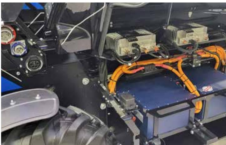
Bei diesem Teleskoplader sind die beiden Akkupakete und die beiden Inverter für den Fahr- und den Pumpenantrieb erkennbar.
